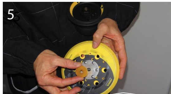
5 Ne pas oublier de repositionner les rondelles avant de remonter le plateau
