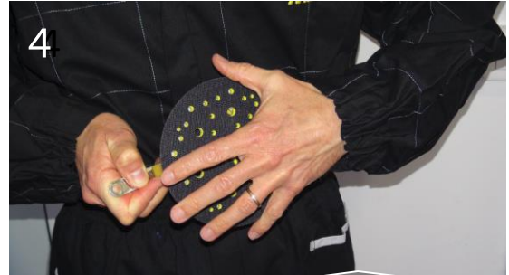
4 Faire tourner le plateau dans le sens inverse des aiguilles d'une montre et retirer le plateau
