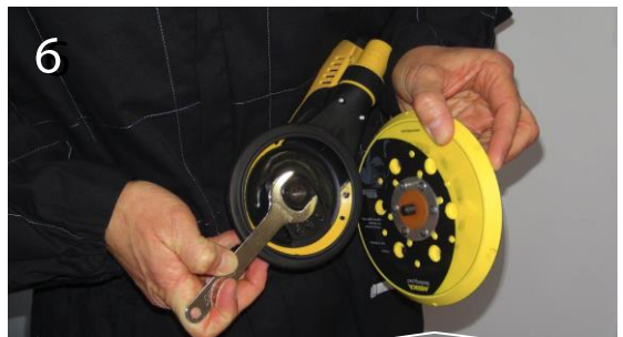
6 Pour remonter le plateau, bloquer l'écrou de l'axe et repositionner le plateau
