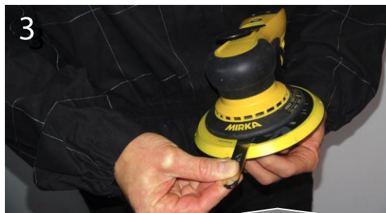
3 Bloquer l'écrou de l'axe
