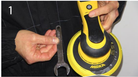
1 Ponceuse Mirka® DEROS (MID6502011) Clé plate 24 mm pour Ø125/150 mm (8995604121)
