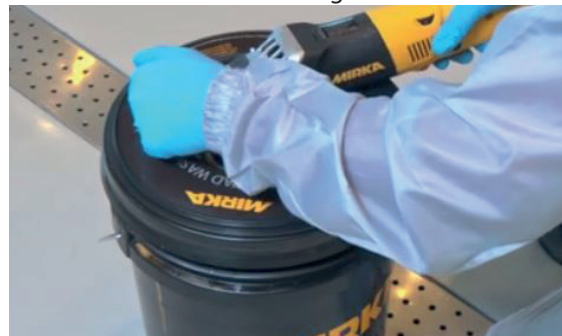
Presser la machine contre la grille, la mettre en marche à environ 800 - 1200 tr/min.
