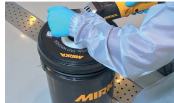
Soulever la machine, la faire tourner à 1500 - 2000 tr/min pour sécher la peau de mouton.
