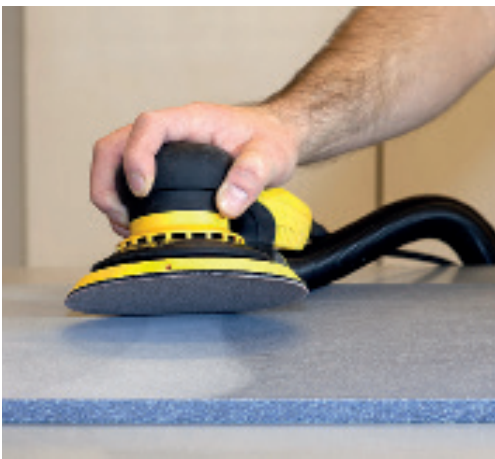
Ylivertainen ja nopea aineen poisto komposiittipintoja työstettäessä.
