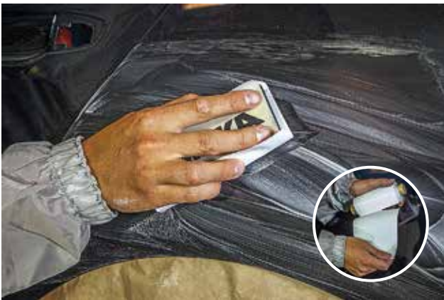
KLARLACK SCHLEIFEN. Das Muster von Aquastar ist so aufgebaut, dass es in jeder Schleifrichtung auf der Oberfläche gleichermaßen effizient ist, was zu einem gleichmäßigen Schleifergebnis führt.
