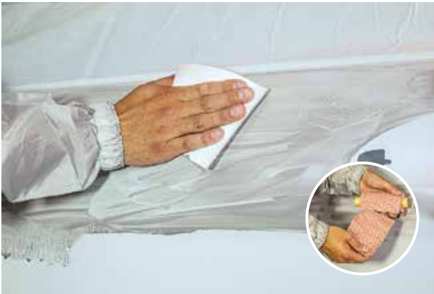
GRUNDIERUNG SCHLEIFEN – FEUCHT. Aquastar zeichnet sich durch Flexibilität, Haltbarkeit und Beständigkeit in Kontakt mit Wasser aus, wodurch das Einweichen des Schleifmittels entfällt.
