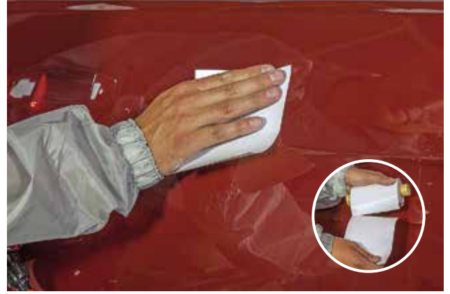
BOYA DÜZELTME. Aynı zamanda ince bir çizik deseni de bırakan Aquastar zımpara tanecığı 2000 ile toz kutuları kolayca çıkarılabilir.
