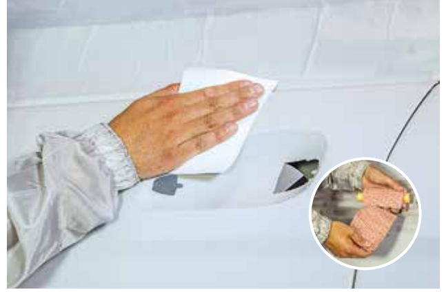
PRIMER ZIMPARALAMA – KURU. Aquastar küçük alanlar ve nokta zımparalaması için kuru olarak da kullanılabilir.
