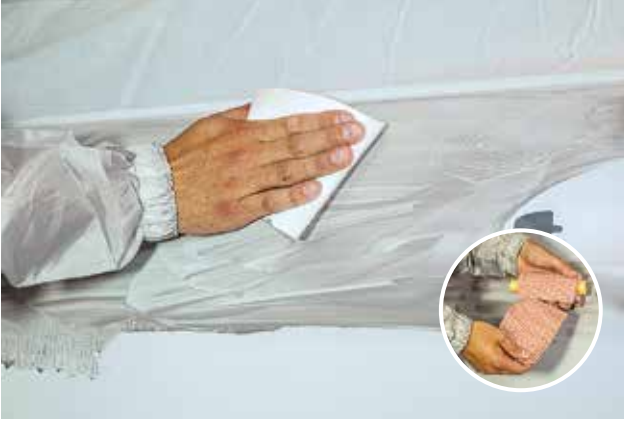
PRIMER ZIMPARALAMA – ISLAK. Aquastar'ın kanal sistemli yapısı su tüketimini azaltır ve tıkanma ve emme etkilerini en az düzeye indirir.
